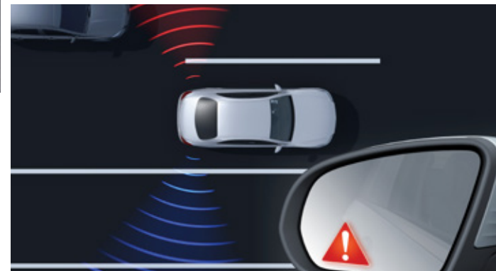
Active Blind Spot Assist ระบบช่วยเตือนเมื่อมีรถอยู่ในจุดอับสายตา
