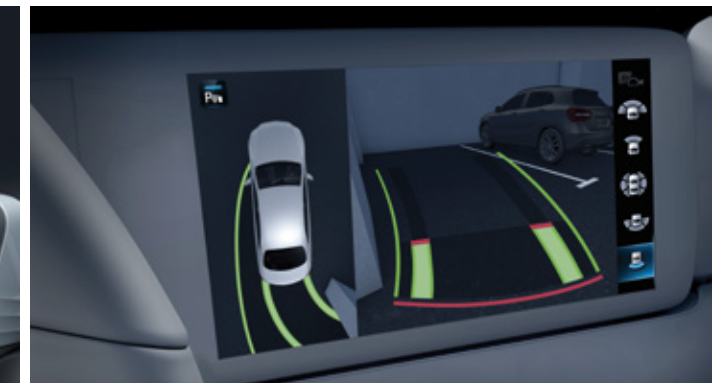
Parking Package with 360-degree camera ระบบช่วยการนำรถเข้าจอดอัตโนมัติ พร้อมกล้องแสดงภาพรอบทิศทาง
