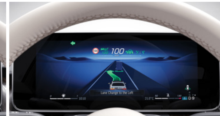
Evasive Steering Assist ระบบช่วยการทรงตัวและดึงรถกลับเข้าช่องจราจร ขณะหลบเลี่ยงสิ่งกีดขวางฉุกเฉิน
